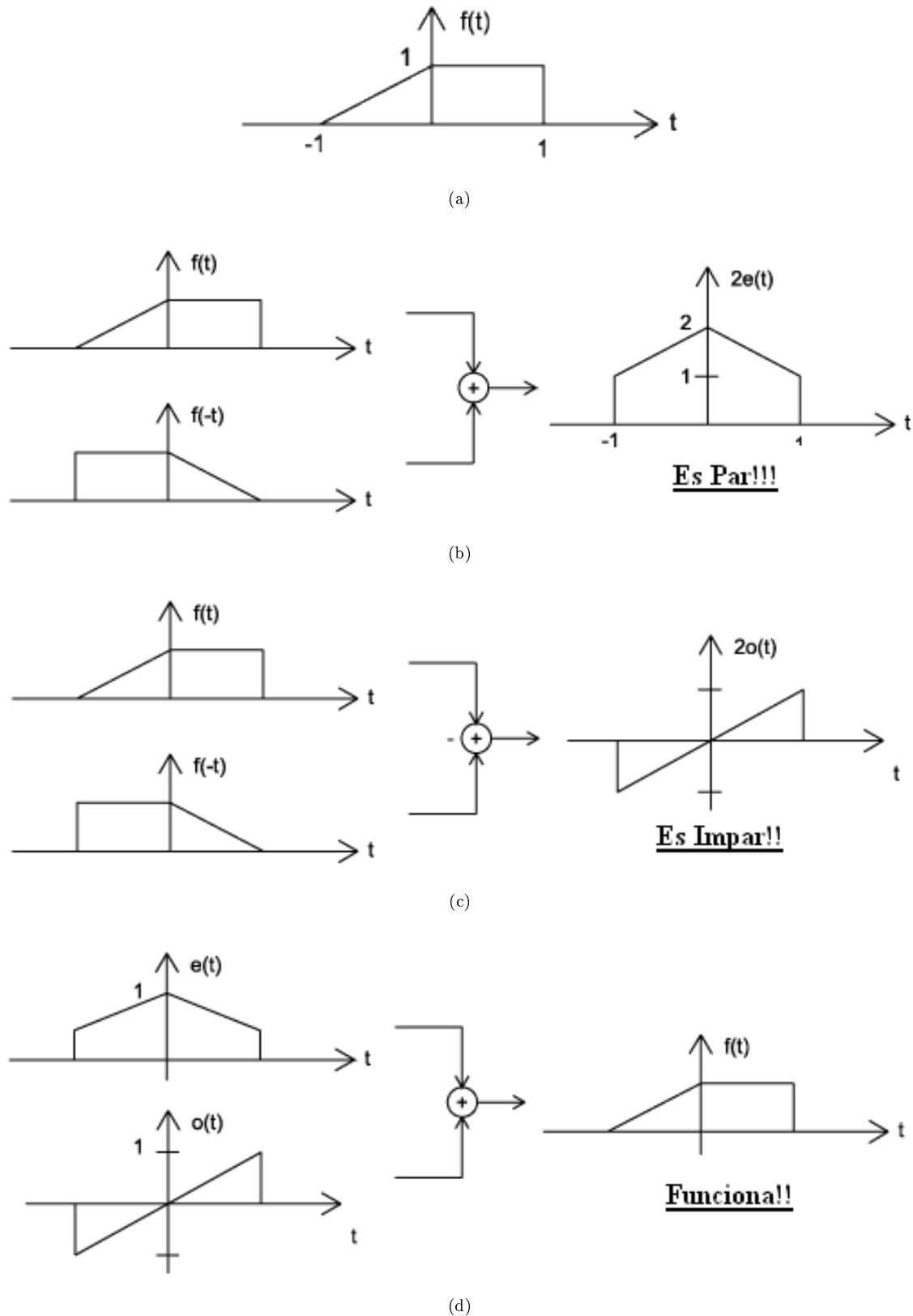
**Figure 1.6:** (a) Esta señal se puede componer a partir de la suma de sus partes par e impar. (b) Parte Par:  $e(t) = \frac{1}{2}(f(t) + f(-t))$  (c) Parte Impar:  $o(t) = \frac{1}{2}(f(t) - f(-t))$  (d) Revisa:  $e(t) + o(t) = f(t)$
