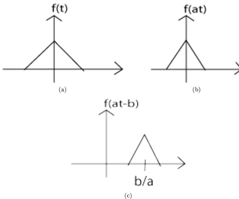
**Figure 2.3:** (a) Empiece con  $f(t)$  (b) Luego reemplace  $t$  con  $at$  para obtener  $f(at)$  (c) Finalmente, reemplace  $t$  con  $t - \frac{b}{a}$  para obtener  $f\left(a\left(t - \frac{b}{a}\right)\right) = f(at - b)$
