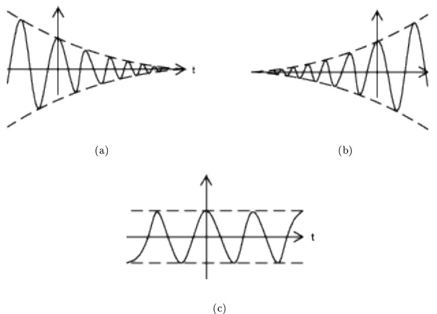
**Figure 5.1:** Las formas posibles para la parte real de un exponencial complejo. Note que la oscilación es el resultado de un coseno con un máximo local en  $t = 0$ . (a) Si  $\sigma$  es negativa, tenemos el caso de una ventana de un exponencial que desciende. (b) Si  $\sigma$  es positiva, tenemos el caso de una ventana de un exponencial que crece. (c) Si  $\sigma$  es cero, tenemos una ventana constante.
