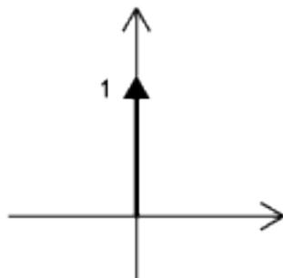
**Figure 4.2:** Por que es difícil dibujar algo que es infinitamente alto, nosotros representamos la Delta de Dirac con una flecha centrada en el punto donde es aplicada. Si queremos escalarla, podemos escribir el valor de escalamiento a un lado de la flecha. Este es un muestreo unitario ( no tiene escala).
