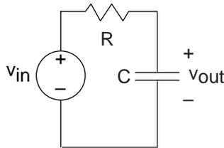
**Figure 1:** A simple RC circuit.
